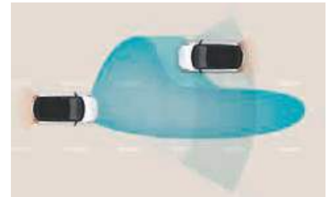
Sistema activo de luces largas (HBA). Menos estrés y máxima visibilidad. El HBA no solo detecta los vehículos que se aproximan de frente, sino también los que circulan delante por el mismo carril, y cambia de luces largas a cortas cuando es preciso.
