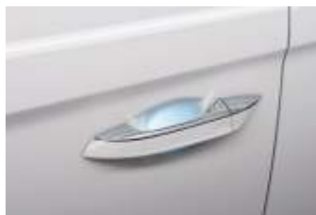
Tiradores iluminados y con detección sensorial de doble canal.
