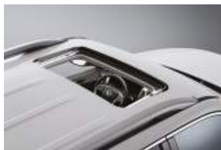
Techo solar eléctrico con función de seguridad.
