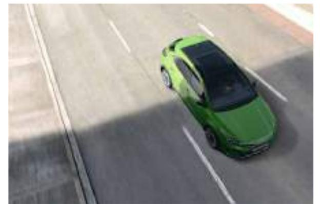
**Asistente de seguimiento del carril (LFA).** El LFA controla la aceleración, el frenado, y la dirección en función de los vehículos que haya delante, haciendo que resulte más fácil y seguro moverse cuando hay atascos. El sistema utiliza una cámara y sensores por radar para mantener la distancia de seguridad con el vehículo de delante, además de monitorizar las líneas de la carretera para que el coche se mantenga en el centro del carril. El LFA funciona entre 0 y 180 km/h.
